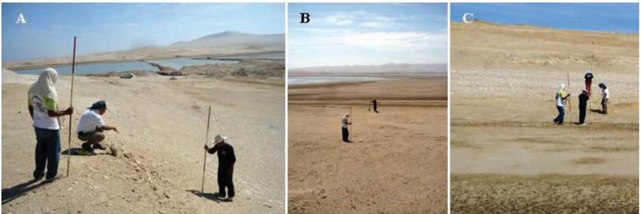
Figura 3.- Levantamiento del perfil 31 del relieve del antiguo fondo de la paleolaguna de Otuma. Zonas del perfil A: superior, B: media, C: inferior
