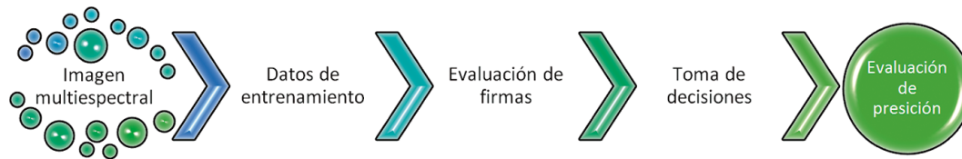
Figura 3.- Etapas de una clasificación multispectral de los datos del satélite
