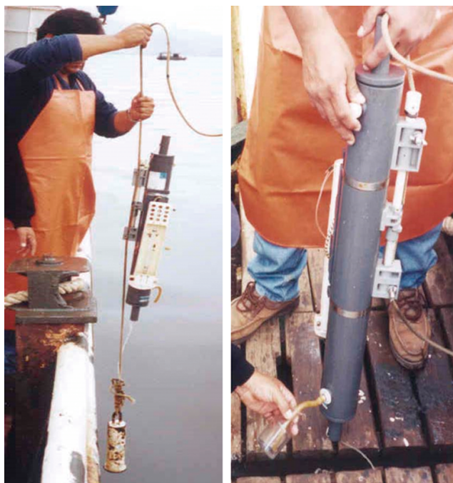
Figura 3.- Botella Niskin, lanzamiento y toma de muestra para análisis de calidad de agua
