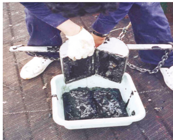
Figura 6.- Muestra de sedimento recolectado con draga van Veen
