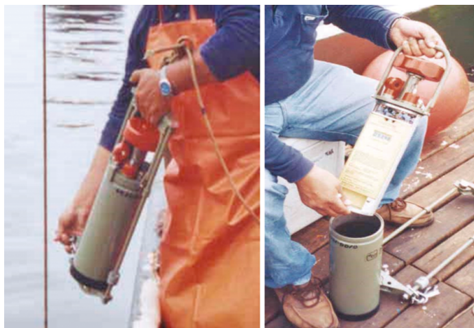
Figura 5.- Lanzamiento y toma de registros de correntómetro RCM9
