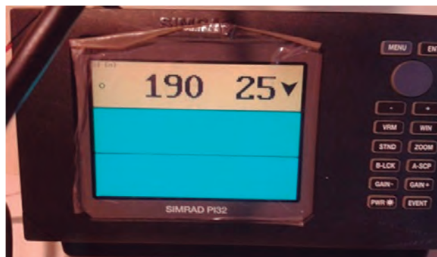
Figura 10.- Netsonda sistema portátil PI32 Simrad con sensor de profundidad
