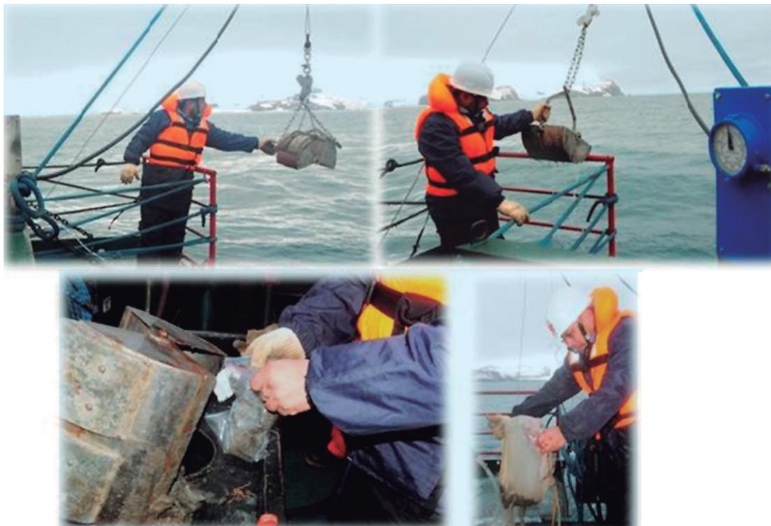
Figura 2.- Lanzamiento, recepción de draga, colecta de muestra y tamizado de sedimento. ANTAR XXI, 2013
