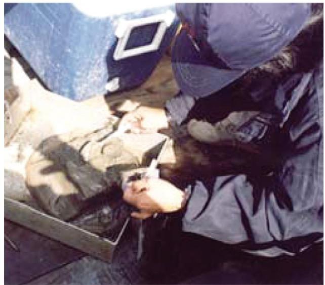
Figura 4.- Colectando los primeros centímetros superficiales de sedimento para estudios sedimentológicos en muestra extraída.
