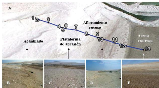
Figura 7.-Vista lateral del relieve del antiguo fondo de la Paleolaguna de Otuma A: imagen satelital del relieve y de los puntos georreferenciados del perfil 31, B: detalles del acantilado, C: de la plataforma de abrasión, D: del afloramiento rocoso y E: de la arena costrosa.
