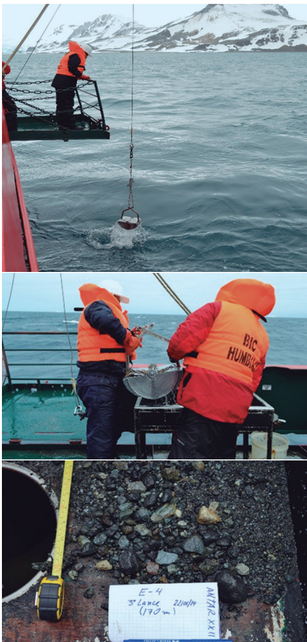
Figura 16.- Lanzamiento, recepción de draga, colecta de muestra y tamizado de sedimentos. ANTAR XXII, 2014
