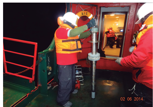
Figura 17.- Saca testigos de sedimentos de gravedad tipo Phleger de 1,75 m de longitud. ANTAR XXII, 2014
