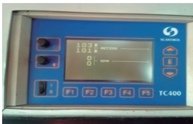
Figura 8.- Controlador de cable principal de arrastre Scantrol
