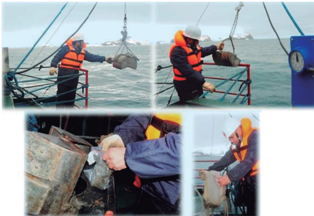
Figura 2.- Lanzamiento, recepción de draga, colecta de muestra y tamizado de sedimento. ANTAR XXI, 2013
